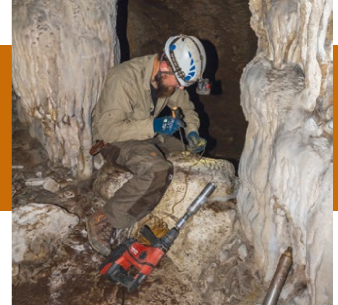
BEPROBUNG EINES FLOWSTONES in der Leontari-Höhle östlich von Athen (Griechenland) mit Hilfe eines Kernbohrers. Foto: A. Busdsky/E. Reichert, Johannes Gutenberg-Universität Mainz
